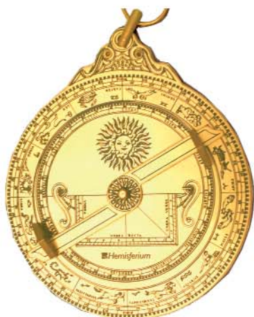
FIGURA 7-5. Astrolabio Plano. Dorso de la Madre, donde se realizan todas las observaciones y medidas. Limbo (círculo que rodea) y Alidada giratoria con sus Pínulas (dos orificios) (Esta es la parte que viene a ser usada para la salida de resultados)
