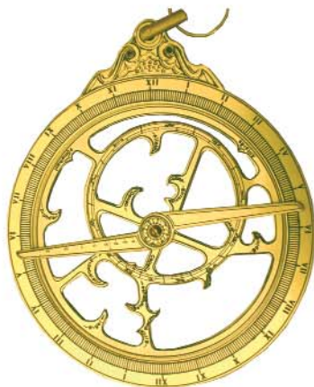
FIGURA 7-2. Astrolabio Plano: Madre, Araña o Red y la Regla para alinear fecha y hora (Esta es la parte que viene a ser usada para la entrada de datos)
