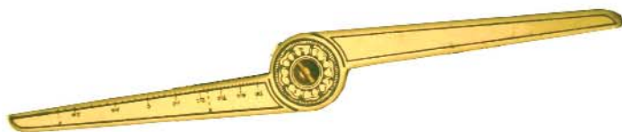
FIGURA 7-3. Regla situada sobre la Araña (Esta parte hace de cabeza lectora)
