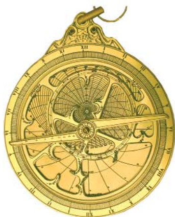
FIGURA 7-1. Astrolabio Plano completo: Madre, Tímpano o Lámina Araña o Red y la Regla para alinear fecha y hora (Máquina completa)
