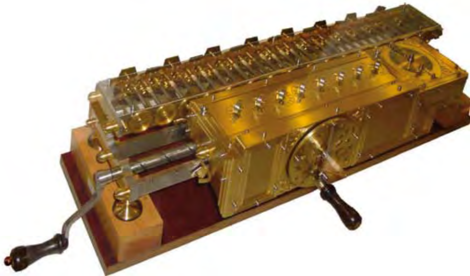
FIGURA 3. Máquina calculadora de Leibniz, primera máquina que sumaba, restaba, multiplicaba y dividía.
